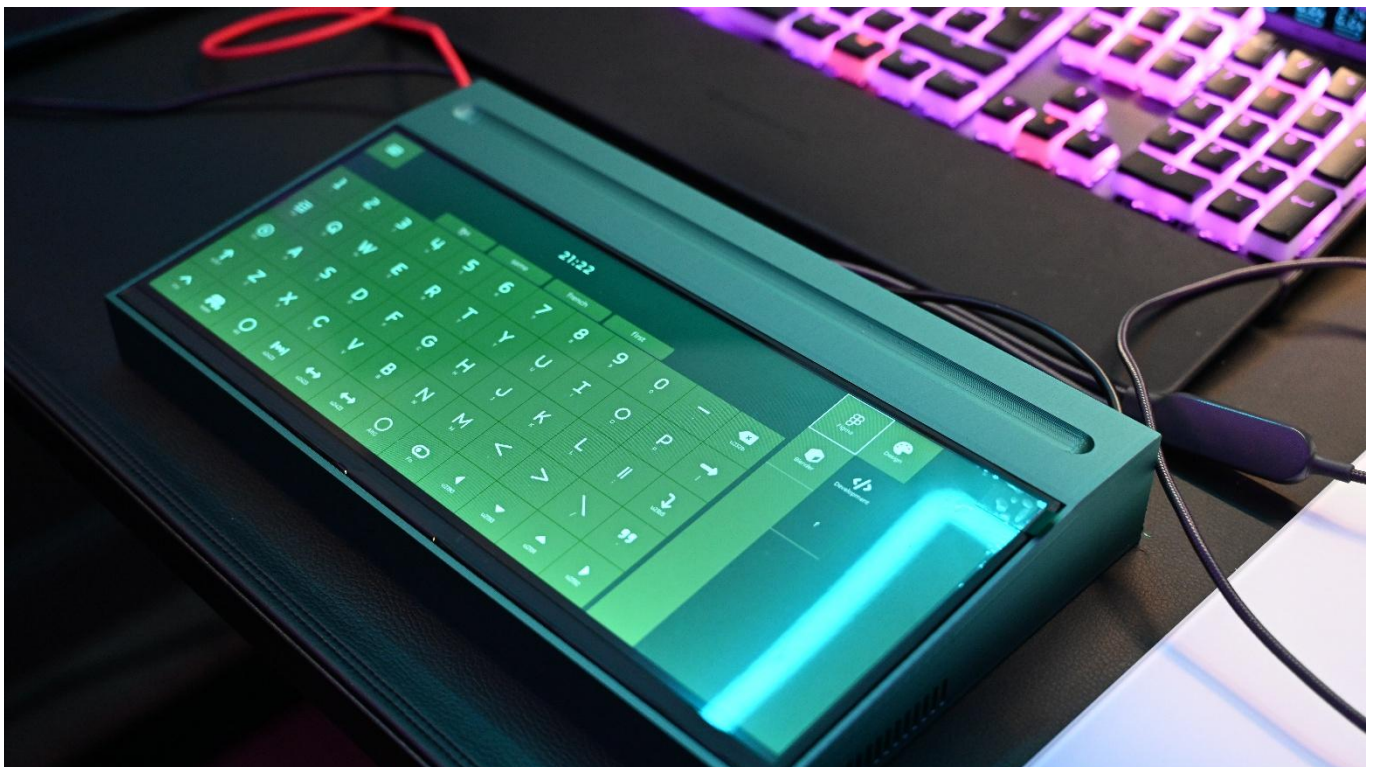
Figuur 3: Starkpad – zij aanzicht. De 3D-geprinte behuizing verbergt de volledige hardware, inclusief de UNO Q, de voeding en de bekabeling.
